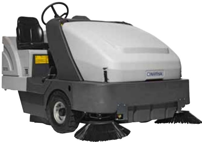
La série SR 1601 comprend cinq modèles avec le choix entre 2 moteurs diesel (2 cyl. et 3 cyl.), essence ou GPL, ou un fonctionnement avec batterie de 48 V pour une utilisation à l'extérieur et à l'intérieur. L'action de nettoyage puissante convient parfaitement au nettoyage des zones de production, des aires de stationnement, des chantiers de construction, des entrepôts, etc.
